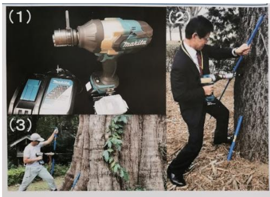
圖 7 日本林業研究單位使用電鑽結合生長錐針對大徑木取得樹輪
